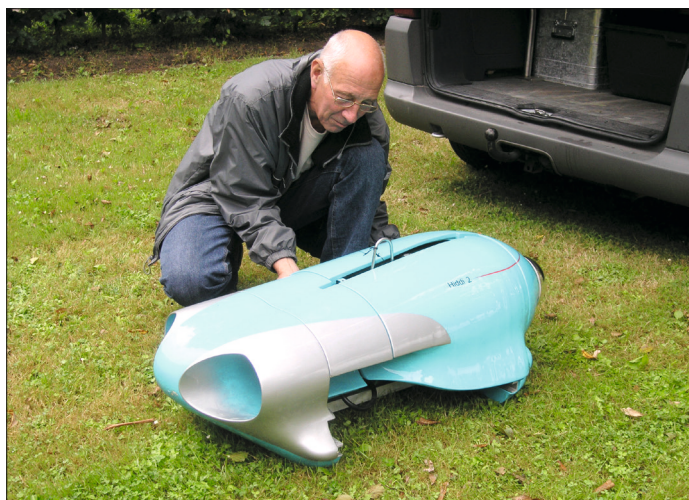
Abb. 10 Hiddi 2. Ferngesteuertes unbemanntes Kameratauchboot (ROV) vor dem Einsatz im Arendsee, Altmarkkreis Salzwedel (LSA).
