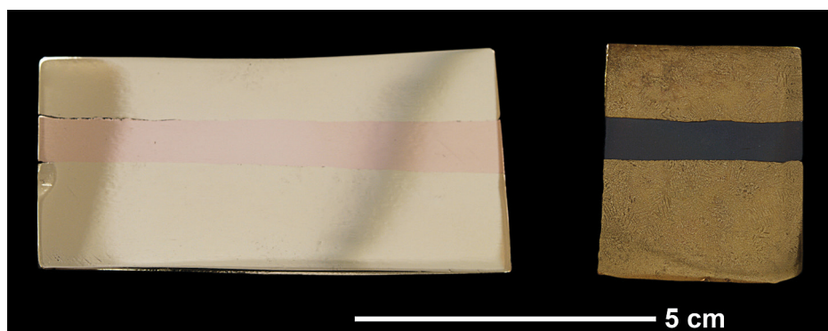
Abb. 15 Mit Kupfer tauschiertes Probestück einer Bronzelegierung mit 10% Zinn: links – nach Überarbeitung und Politur, rechts – nach Patinierung in menschlichem Urin.
