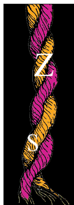
Abb. 15 Schematische Darstellung eines sZ-Zwirns.
