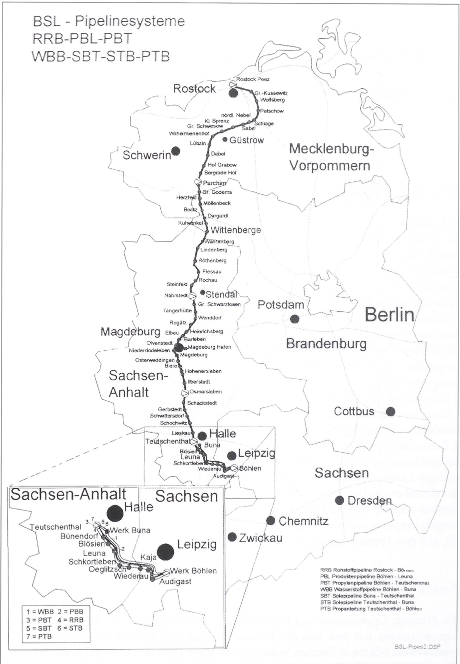
Abb. 1: Gesamtverlauf der Pipelinesysteme der Buna Sow Leuna Olefinverbund GmbH (BSL). Während von Böhlen bis Teutschenthal, Ldkr. Saalkreis, fünf Leitungen verlegt werden, reicht eine Rohstoffleitung von Böhlen bis Rostock.
