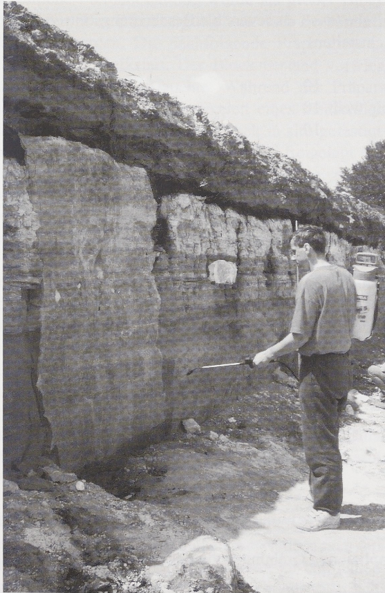
Abb. 2: Anfertigung eines großen Lackprofils: Aufspritzen einer verdünnten Reiacrylat-Microdispersion Carbozet 514 H auf eine Lage mit Mullbinden (Tagebau Königsau, Ldkr. Aschersleben-Staßfurt, Lackprofil vom ehemaligen Ascherslebener See)
