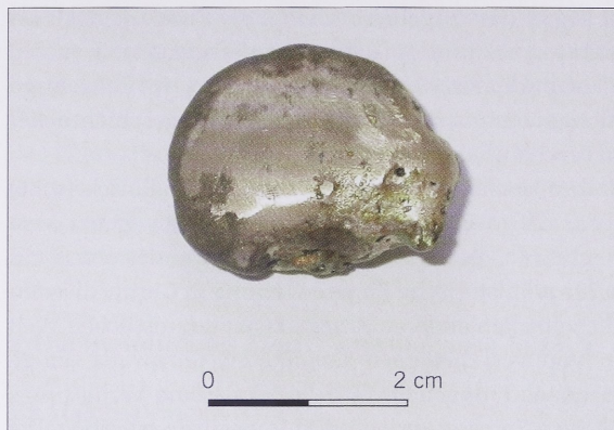
Abb. 2 Beim Schmelzexperiment erhaltener Bronzeregulus.
