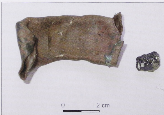
Abb. 1 Kupfer (31 g) wurde mit dem abgebildeten 3,8 g schweren Stück Zinnstein unter Holzkohle 30 min auf 1200^\circ\text{C} erhitzt.
