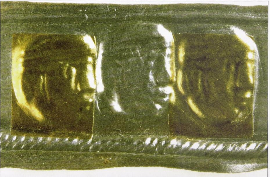
Abb. 9 Werkprobe zur reinen Diffusionsvergoldung mit definierten Flächengrößen. Das Silberblech wurde mit kleinen zugeschnittenen Goldblechen vergoldet und anschließend das Muster eingepunzt.
