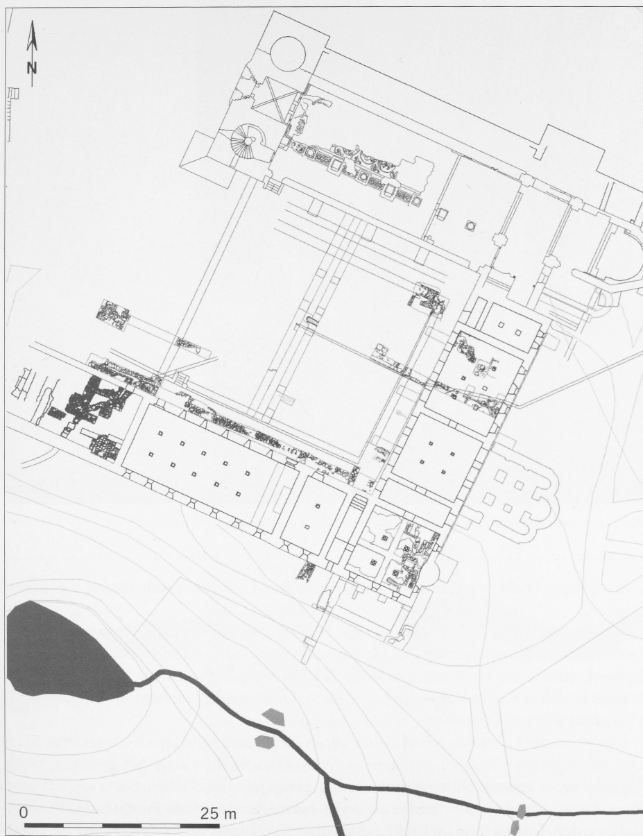
Abb. 11 Kloster Ilsenburg, klausurinternes Wassersystem nach aktueller Befundlage.
