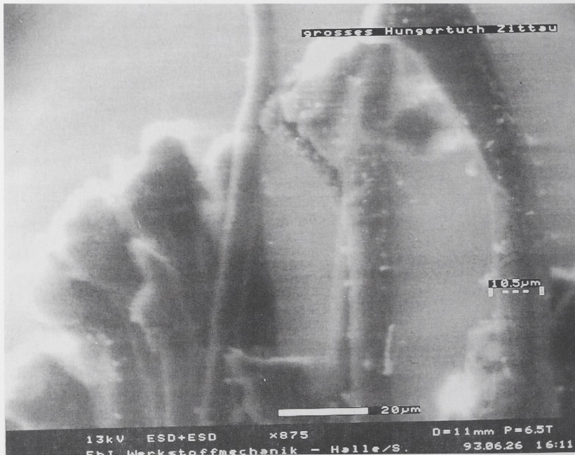
Tafel 12: 1 wie 11.1, einzelne Leinenfaserenden, freitragend; 2 wie 11.1, bemaltes Stück des Leinenfadens
