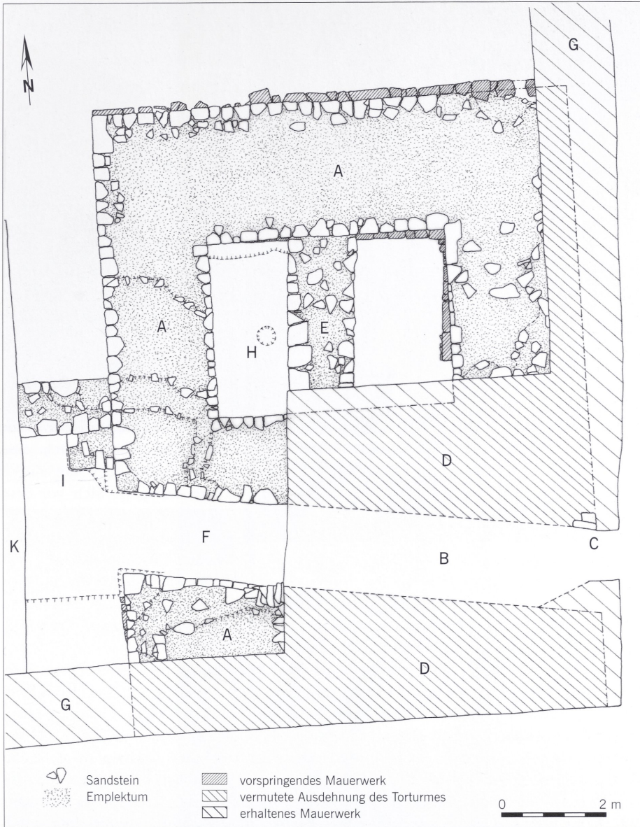
Abb. 15 Schnitt E – Planum der aufgedeckten romanischen Torturmreste mit anschließenden Befunden. A–Torturm B–Tordurchlass C–Eckverband Torturm D–»gotischer Turm« E–Stabilisierung des »gotischen Turmes« F–Gewölbefortsetzung G–abgehende Kurtinen H–muldenförmige Vertiefung I–Pfeilervorlage K–spätmittelalterlich-frühneuzeitlicher Bau
