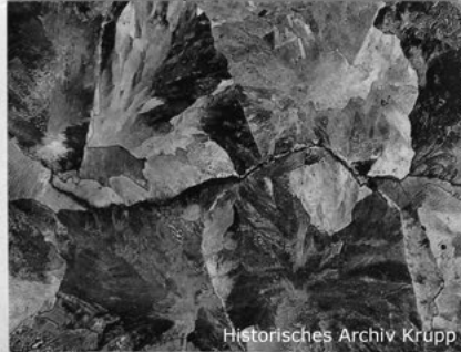
1 Rissiger Bohrkernabschnitt 40 m/m Ø von Rotor 156690 aus E F 664 L (Ch.1 E M 4940), in: Untersuchungsberichte Band II , June 1929, Essen, Historisches Archiv Krupp
