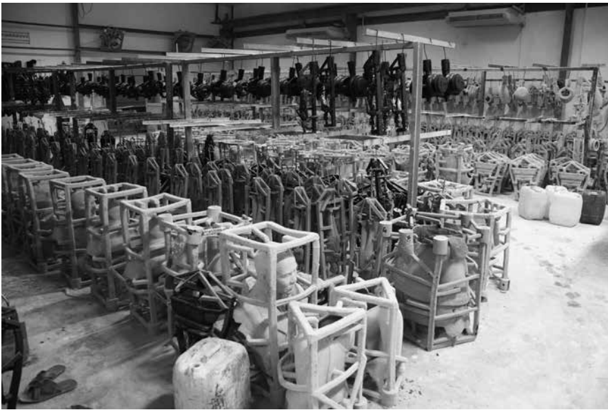
5 Ceramic-Shell-Formenbau für den Bronzeguss bei Asia Fine Arts, Ayutthaya, Thailand.
