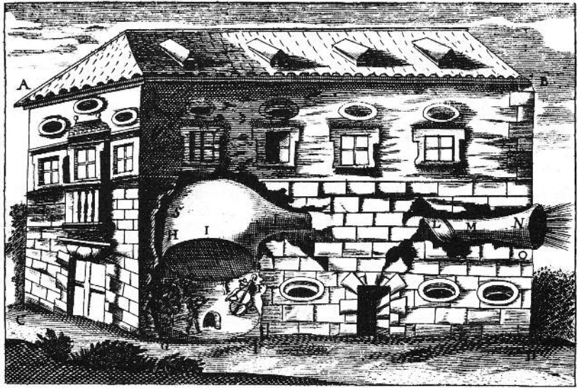
Abb. 3 Raumakustische Konstruktion zur Außenbeschallung „Wie man mancherley Instrumentalmusic in die Weite auch zu Gehör bringen könne“, aus: Athanasius Kircher, Neue Hall- und Thonkunst , Nördlingen 1684 (Reprint, Hannover 1983, S. 103)
