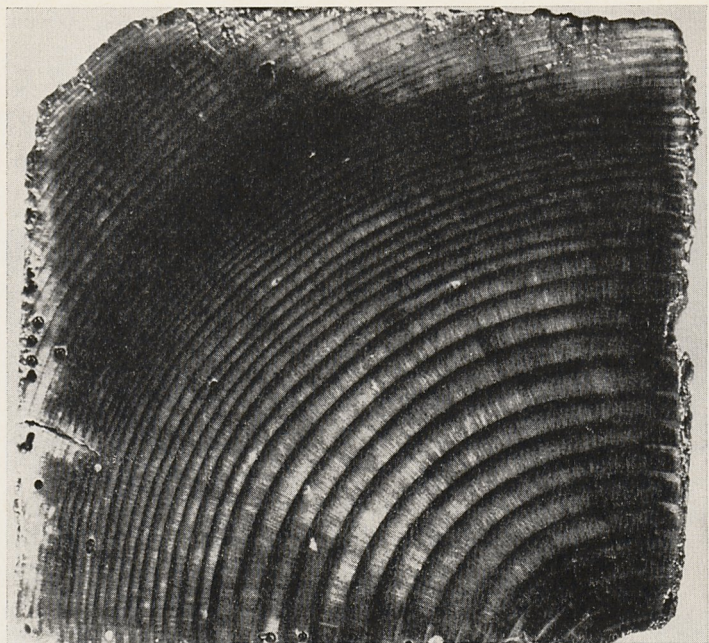
Abb. 4b Tannenrühlholz aus der konstantinischen Palastaula in Trier. Querschnitt mit Waldkante.
