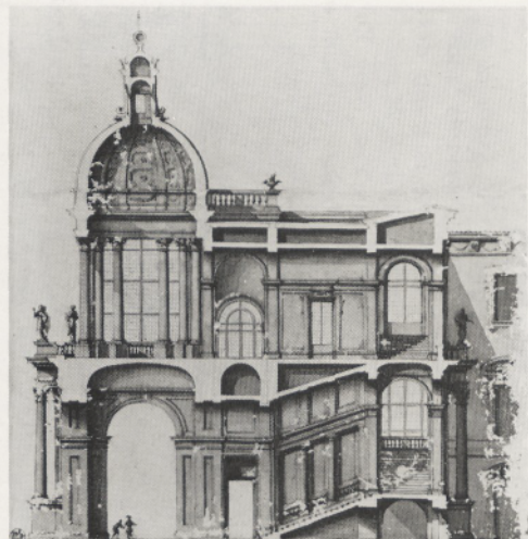
Abb. 6a Carlo Fontana: Querschnitt durch „Ein- gangsbau“ mit Treppen- haus und Kuppel. Ber- lin, Kunstbibliothek Hdz. 1154, Kat. Nr. 394
