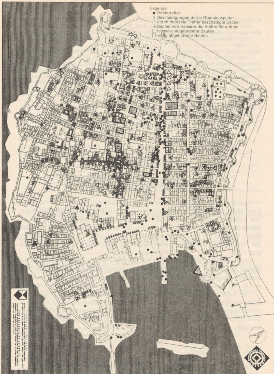
Fig. 1 Dubrovnik, erste Übersicht über die Schäden der Bombardierung vom 6.12.1991. Unesco, Inst. f. Denkmalschutz Dubrovnik (nach Prospekt zu: Kunstschätze von Dubrovnik, hrsg. v. ITP Marin Držić, Zagreb 1992)
