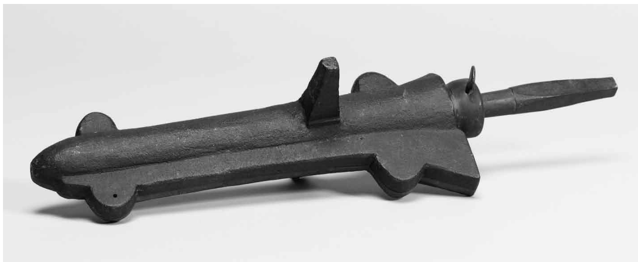
Gussform für eine Kerzengussform, um 1850, Gusseisen, punziert. L. 46 cm, L. Hohlform 29 cm, Dm. 2,9 cm. Inv.-Nr. Z 2096.
