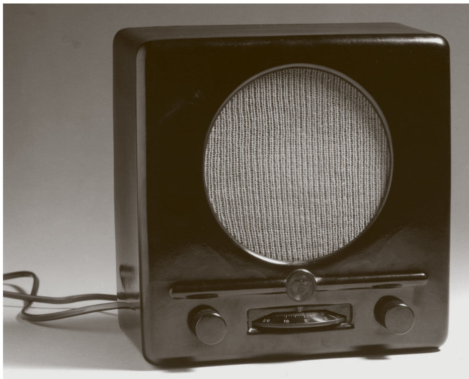
Volksempfänger Typ DKE 38 (Deutscher Kleinempfänger 1938). Schwarzes Bakelit-Gehäuse, Schallöffnung mit originaler Stoffbespannung, über Sender-Wählscheibe eingepreßt Reichsadler mit Hakenkreuz im Eichenkranz, originale Innenausstattung mit Röhren VY 2 und VCL 11, Originalstecker, für moderne Schukosteckdosen zurechtgeföhlt, Stromkabel erneuert, Rückwand aus schwarzer Hartpappe, in der oberen Hälfte für den Luftaustausch gitterartig perforiert, in der unteren Abziehbild mit Händler-Adresse „Karl Linselen, Innsbruck, Burggr. 2“ sowie Aufdruck technischer Betriebsanweisungen, der Modellbezeichnung „Deutscher Kleinempfänger 1938“, des VDE-Zeichens (Verband Deutscher Elektrotechniker) und der Herstellerangabe „Radio H. Mende & Co.“, H. 24 cm, B. 24 cm, T. 12 cm. Inv.-Nr. HG 13204. Erworben 2007.
