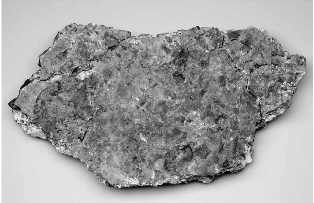
Abb. 3: Fragment eines Ziegelestrichs, Nürnberg, wohl 14./15. Jahrhundert, H. 15 cm, L. 52 cm, B. 29 cm, Inv. A73 (Foto: Monika Runge).
