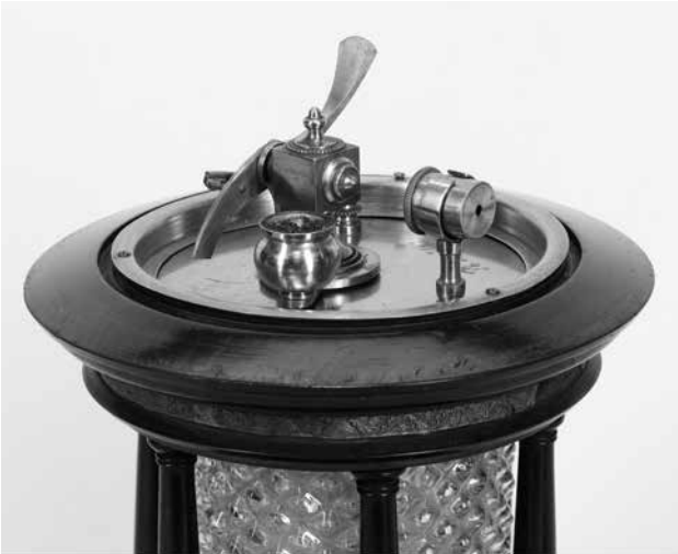
Abb. 2: Der von Johann Wolfgang Döbereiner entwickelte Zündmechanismus unter der abnehmbaren Kuppel des Feuerzeugs (Foto: Georg Janßen).
