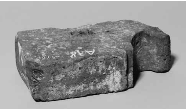
Profilziegel von der St.-Michaels-Kirche in Pestlin, Westpreußen, Mitte 14. Jahrhundert, L. 29,5 cm, Br. 13,5 cm, H. 8,5 cm, Inv.-Nr. A 78.
