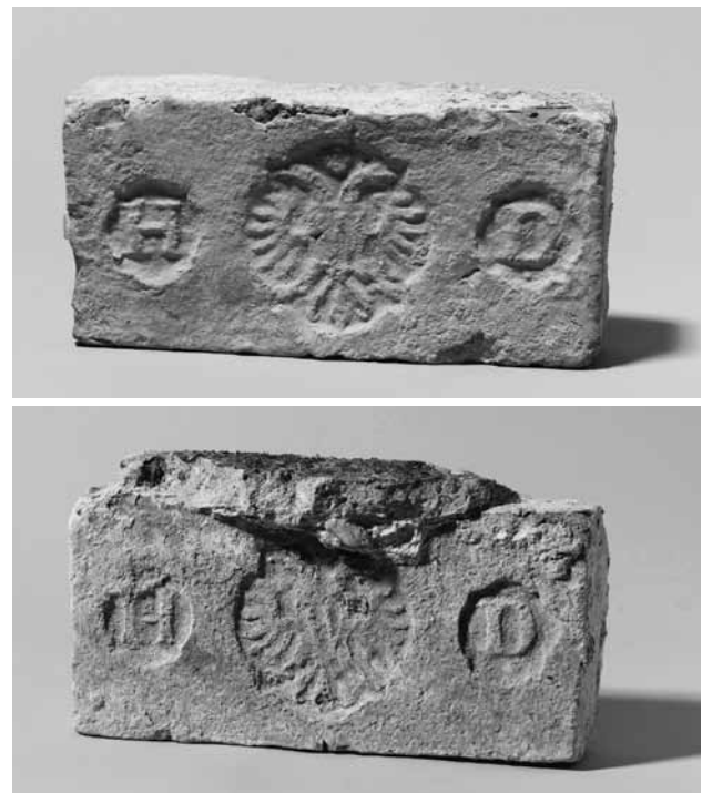
Zwei Ziegel vom Wiener Wohnhaus Hofstattgasse 4, Wienerberger Ziegelfabrikations- und Baugesellschaft, Wien, um 1870/80, L. 29 cm, Br. 13 cm, H. 7 cm, Inv.-Nr. A 4031/4032.
