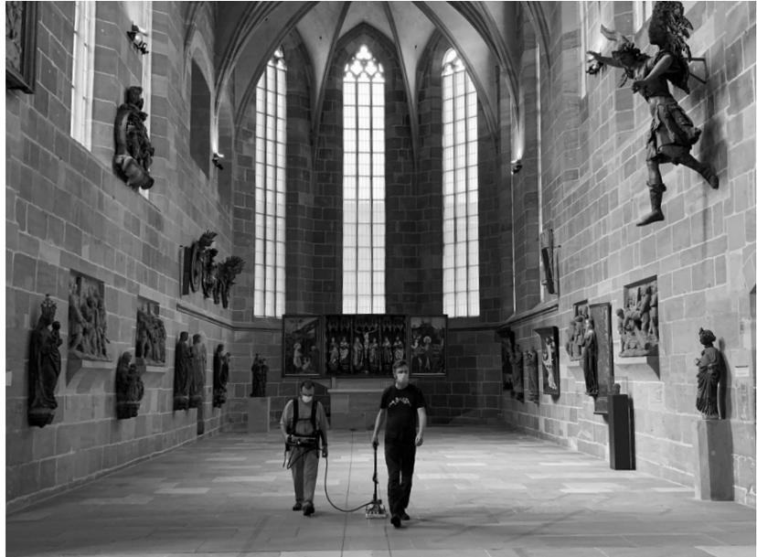
Abb. 4: Mitarbeiter des Bayerischen Landesamts für Denkmalpflege bei der Georadarmessung im Kirchenschiff des Kartäuserklosters. Die Messung wurde im Juni 2020 unter Einhaltung der damals geltenden pandemiebedingten Hygienevorschriften durchgeführt (Foto: Angelika Hofmann).
