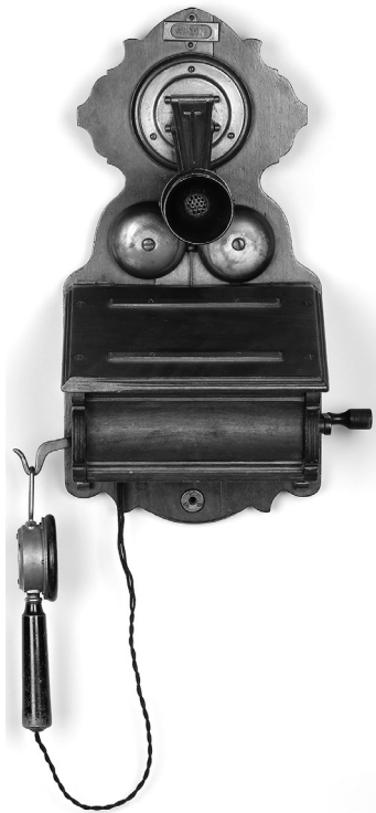
Abb. 1: Fernsprechapparat OB 04, Wandtelefon Siemens & Halske, 1904, Holz, Messing, vernickelt, Elektrotechnik, H. 47 cm, B. 32 cm, T. 19 cm (ohne herabhängenden Hörer), Hörer: 24,5 x 8 cm, Inv. Des1867 (Foto: Monika Runge).
