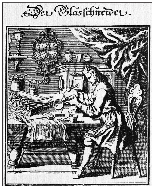
Abb. 7: Christoph Weigel: Der Glasschneider, um 1680. In: Erich Meyer-Heisig: Der Nürnberger Glasschnitt des 17. Jahrhunderts (Jahresgabe des Deutschen Vereins für Kunstwissenschaft 1963). Nürnberg 1963, S. 6: Hier fehlt das Fußpedal unter dem Tisch, das das Schwungrad antrieb (Scan: GNM).
