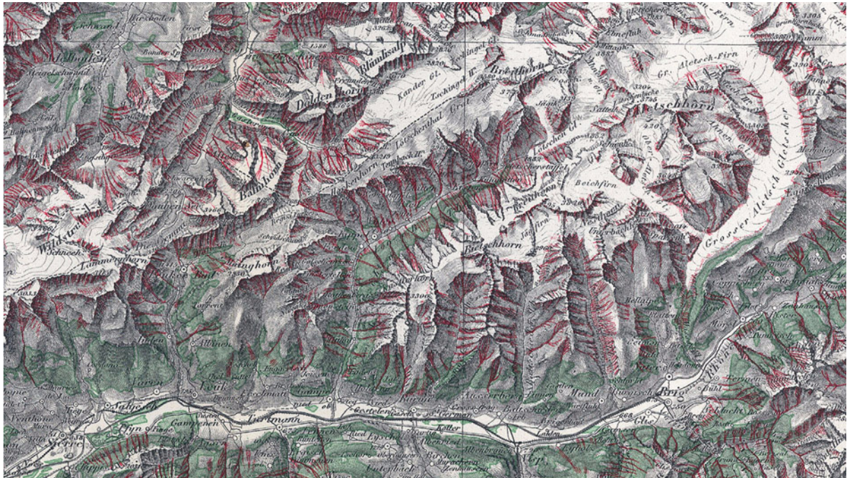
Abb.2: Lawinenkarte, Ausschnitt vom Lötschentale. Darin als rote Linien gekennzeichnet die realen und potenziellen Lawinenabgänge (Coaz 1910, Statistik, Blatt 3).
