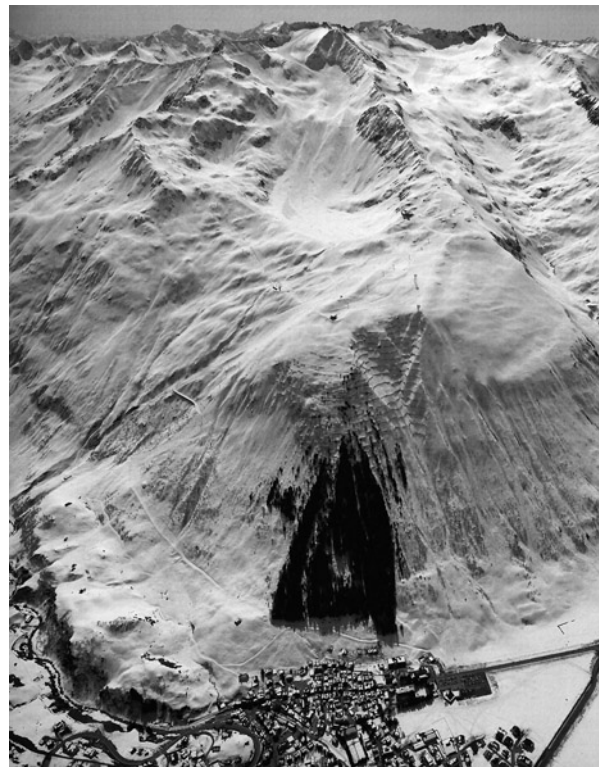
Abb.12: Schutz- bzw. Bannwald und Lawinenbebauung oberhalb von Andermatt ( Die Schweiz von oben , hg. v. Emil Zopfi, Zürich 2004, S. 105).
