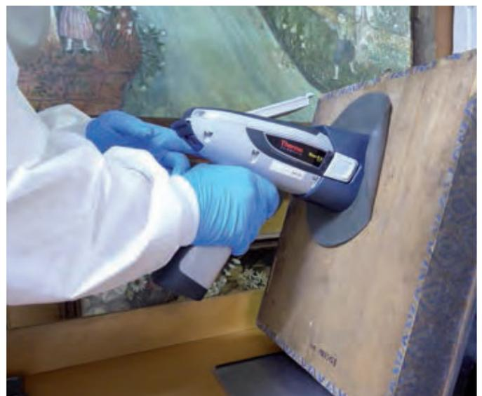
**GERÄTE ZUR PORTABLEN RÖNTGENFLUORESCENZANALYSE (P-RFA)** werden für die chemische Analyse archäologischer und kunsthistorischer Objekte eingesetzt.
