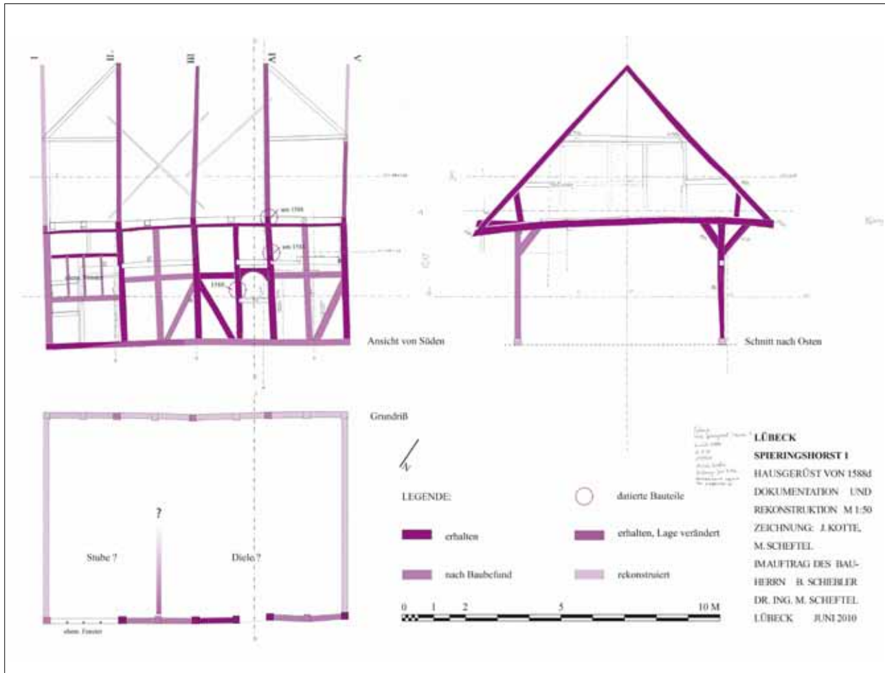
Abb. 9: Gerüst eines Fachwerkbaus von 1588& im Haus Spieringshorst Nr. 1.
