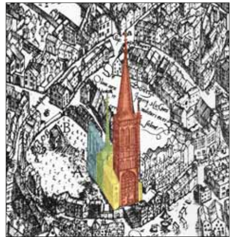
Abb. 1: Die Salvatorkirche auf dem Plan des Johannes Corputius (1566). Die Graustufen markieren Westturm, basilikales Langhaus, Querhaus mit Dachreiter und Langchor.
