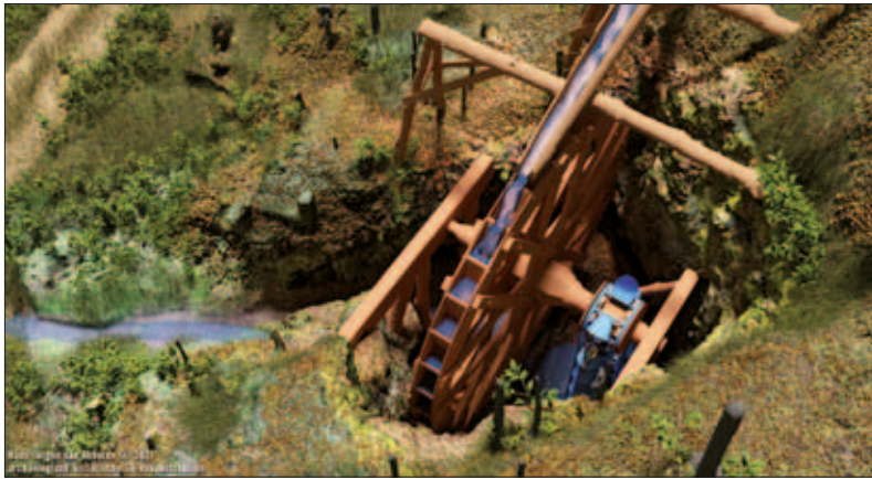
4 Zeichnerische Rekonstruktion der möglichen Wasserkunst. Es handelt sich um ein Kanonenwerk mit einem Raddurchmesser von 10 m.
