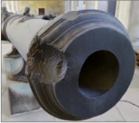
9 Treffer an der verstärkten Rohrmündung eines Geschützes aus dem 16. Jahrhundert (Geschützhalle, Heergeschichtliches Museum Wien).
