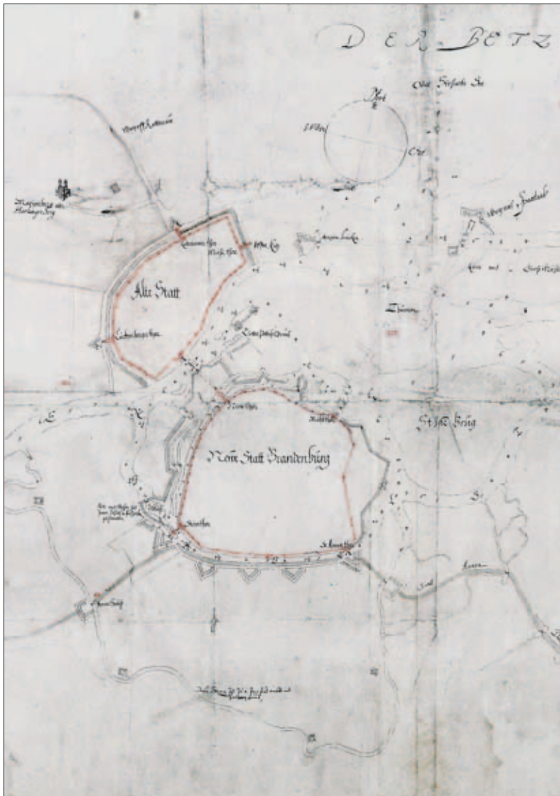
3 Plan der Stadt Brandenburg mit Eintragung der vorhandenen Befestigungsanlagen, Gräben und Gewässer sowie der zu errichtenden Schanzanlagen 1631.
