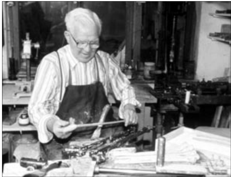
Abb. 4: Der letzte erwerbsmäßig produzierende Pfeifenbäcker des Westerwaldes, W. A. Simonis in Hilgert, beim Entnehmen eines Pfeifenrohlings aus der geöffneten Form, aufgenommen 1995.
