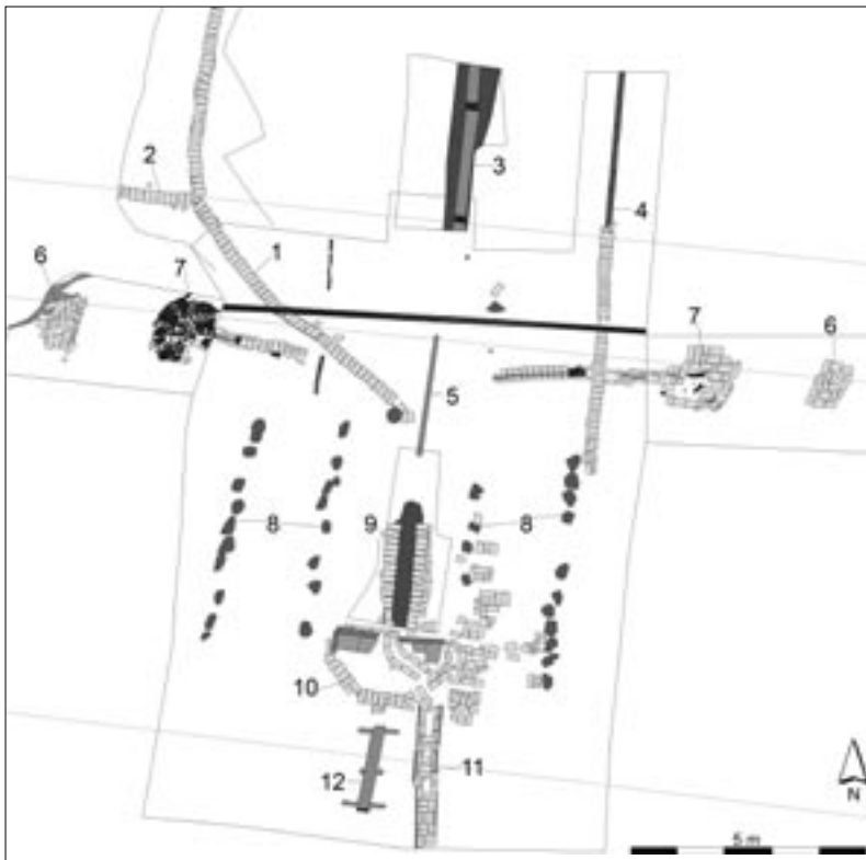
Abb. 4: Unterste Treppen- und Kaskadenanlage: 1 Ziegelleitung zur Kaskadenbewässerung; 2 Zuleitung von Wasser aus Schichtquellen am Westrand der Terrasse; 3 Druckleitung aus Holz; 4 Tonrohrleitung aus den jüngeren Nutzungsphasen des Gartens; 5 Druckleitung aus Blei; 6 Ziegelpostamente; 7 Wasserspiele; 8 Bereich der ehemaligen Treppen mit Begrenzung aus Feldsteinreihen; 9 Ziegelverschalung der Druckleitung aus Blei; 10 Kaskadenbecken; 11 Ziegelleitung zur Kaskadenentwässerung; 12 Druckleitung aus Holz (Grafik: N. Lau).
