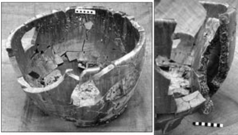
Abb. 4: Glashütten, Hochtaunuskreis. Glashütte »Unterhalb Dornsweg«. Zerbrochener Glashafen mit ausgelaufener Glasmasse (nach Steppuhn 2003b, Abb. 5. Fotos: Gilbert Harke, Lübeck).
