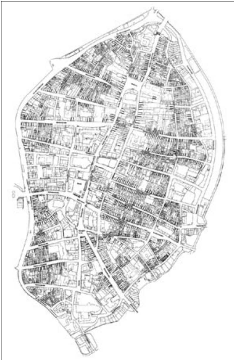
Abb. 2: Lübeck, Kartierung der heute noch nachweisbar oder zumindest erschließbar erhaltenen mittelalterlichen Brandmauern zwischen Vorderhäusern. In der Stadtmitte durch Abrisse des 19./20. Jahrhunderts bereits ausgelöscht. Bemerkenswert, wie oft mit dem Übergang von giebel- zu traufenständiger Bebauung die Brandmauern aussetzen.
