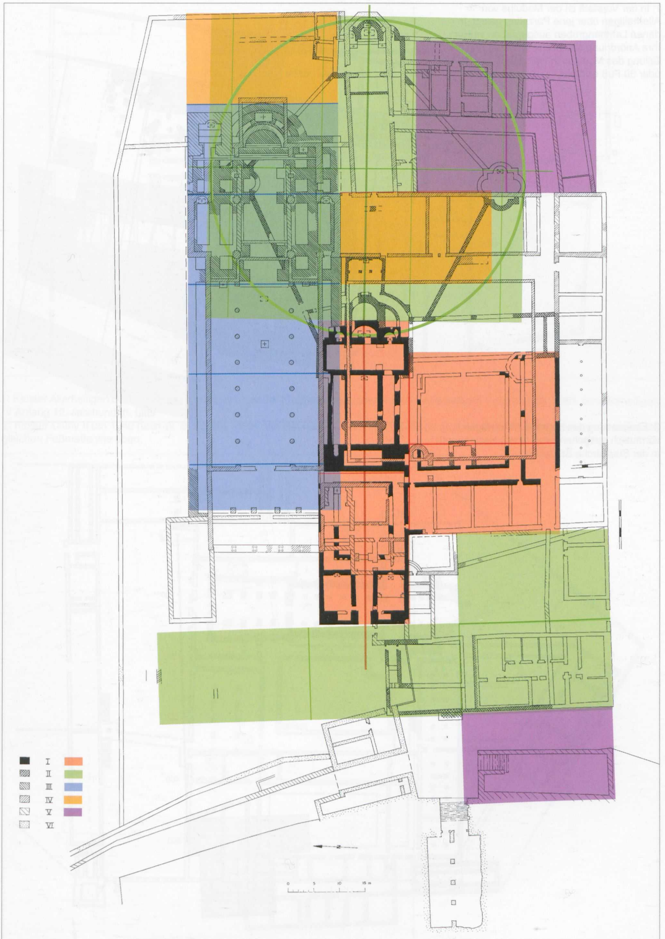
Modulus von 17,5 x 29,5 m und seine Anwendung in den verschiedenen Bauphasen des Klosters Allerheiligen (2. Hälfte 11. bis 12. Jahrhundert). Der Kreis umfaßt die Kapellen des schriftlich überlieferten Kreuzhofes: »... Kapellen, ... kreuzförmig nach seinem Plan in einem Kreise angelegt ...«.
