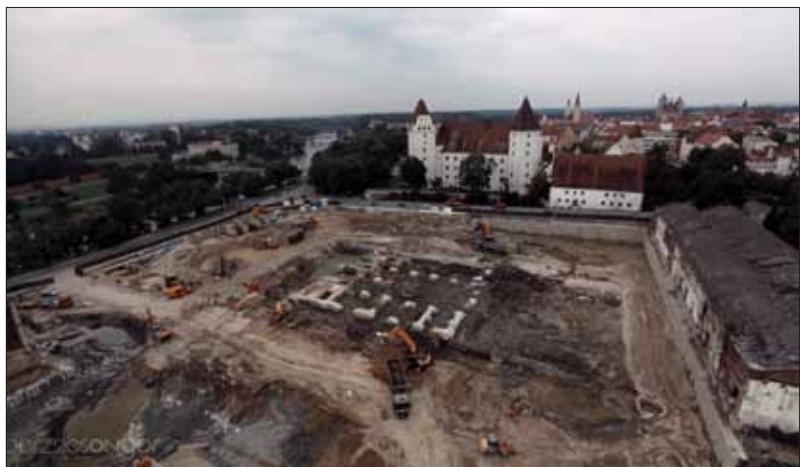
Abb. 3: Luftbild der Grabungsfläche. Am rechten Bildrand die Kanonenhalle der Kgl. Bayerischen Geschützgießerei und Geschößfabrik; in der Bildmitte die Fundamentreste einer Produktionshalle; im Hintergrund das Neue Schloss.
