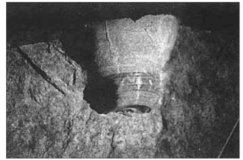
Abb. 22: Gebrochenes steinernes Achslager einer senkrechten Achse aus Tovstrup.
