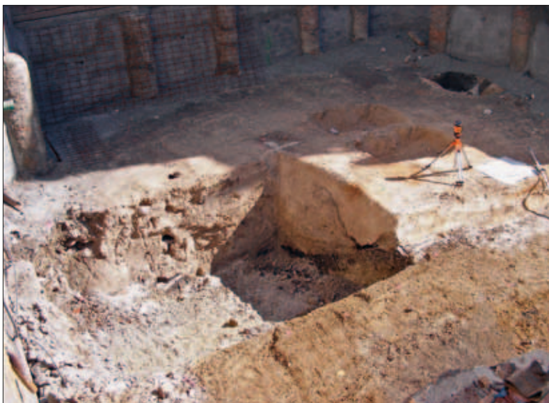
Abb. 4: Aufschluss in der Olgastraße 101. Der nördliche Bereich des Aufschlusses ist dominiert von fluviatil entstandenem Kalktuff; über ein Sondageloch konnte der steile Abfall des Uferrands erfasst werden. Blick nach Nordost.
