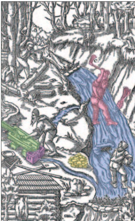
△ Abb.17: Techniken des Seifenabbaus um 1556, farblich markiert (Holzschnitt, Georg Agricola). Rot: Abgraben von zinnhaltigen Sediment; blau: Waschgraben; grün: über Holzrinnen weitere Fraktionierung und Anreicherung; lila: Zinnsubstrat in Waschkästen aufgefangen; gelb: ausgeseiftes Material (Raithalde).
