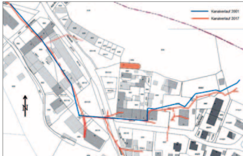
Abb. 6: Auszug aus dem Kataster mit den Eintragungen des unterirdischen Kanalverlaufs von 2001 (blau) sowie den Ergebnissen der Untersuchung der Wasserführungsstollen von 2017 (rot) (vergleiche Abb. 7).
