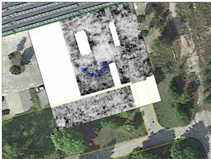
Abb. 5: Georadaruntersuchung von 2015. Die halbkreisförmige Eintragung zeigt Anomalien durch Baustrukturen.
