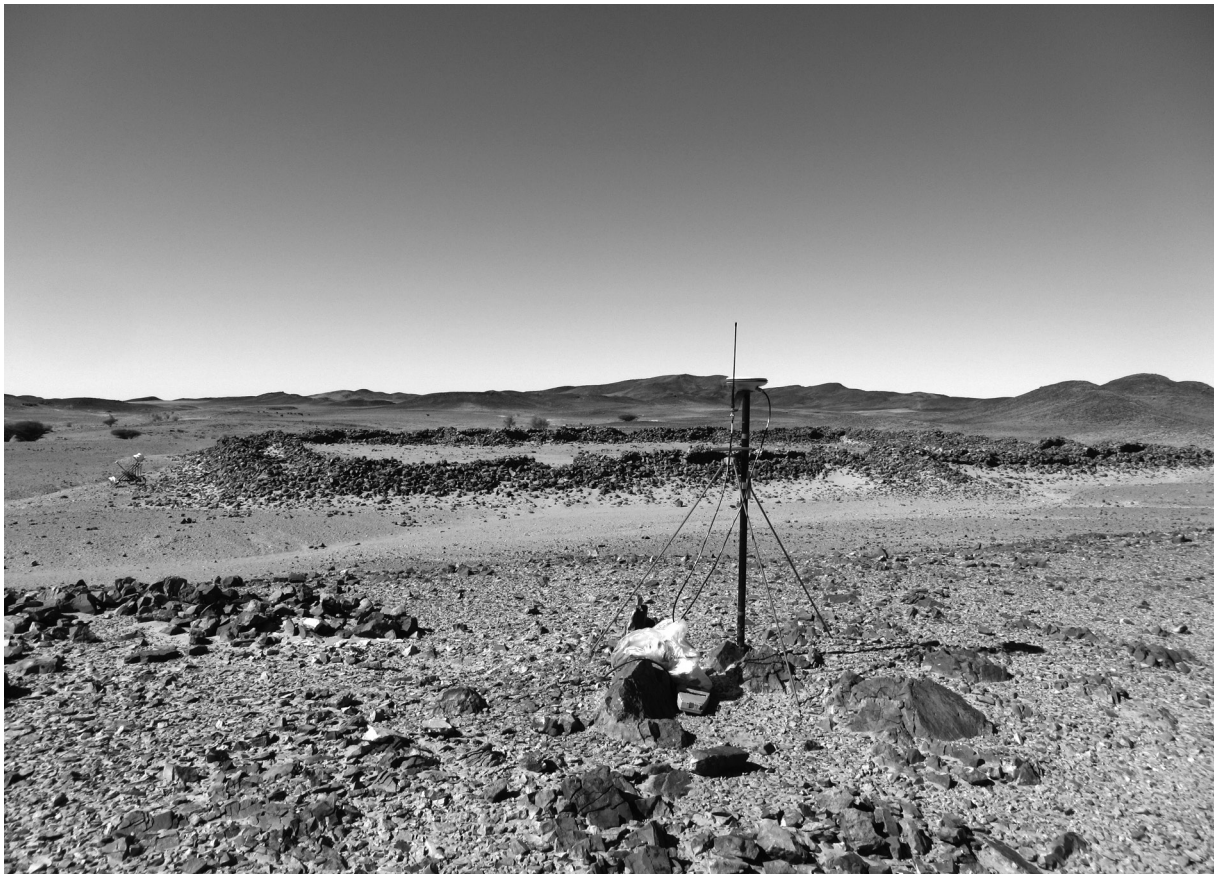
Abb. 3: In der Nähe des Meßfeldes aufgebaute GPS-Basis-Station.
