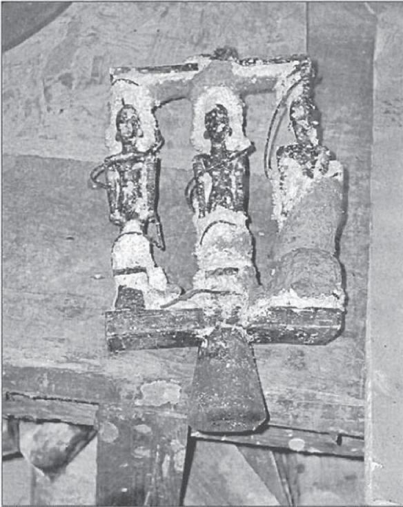
Abb. 7: Freilegen der Rohgüsse. Erkennbar ist der Armierungsdraht, der zur Stabilisierung beim Formenaufbau eingeflochten wurde.
