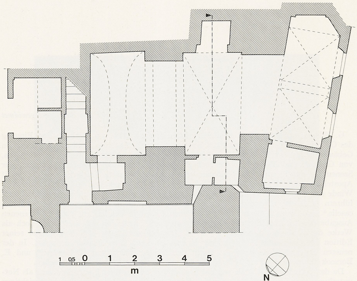
1 Ehemaliger Turm von S. Agostino in Siena. Grundriss des Untergeschosses im heutigen Zustand (mit Angabe der für Abb. 7 gewählten Schnittfläche).
