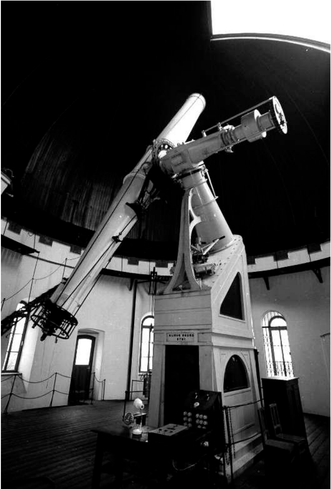
Figure 15.4: The main telescope, a 27-inch refractor, Grubb of Dublin (1878) (Institut für Astronomie der Universität Wien)
