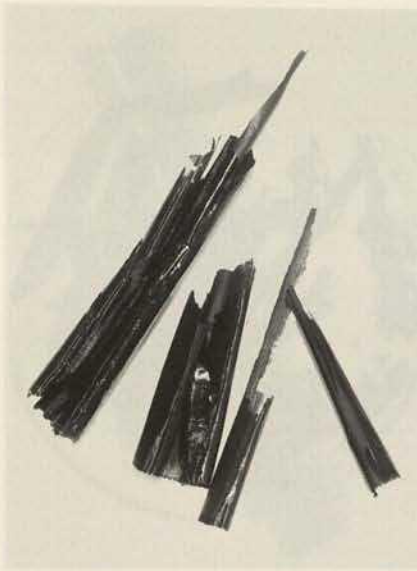
△ Abb.18. Probe 2 b: 30 % Rohlack, 70 % Resikleister, freier Aufstrich Fig. 18. Sample 2 b: 30 % raw lacquer, 70 % rice starch, free film
