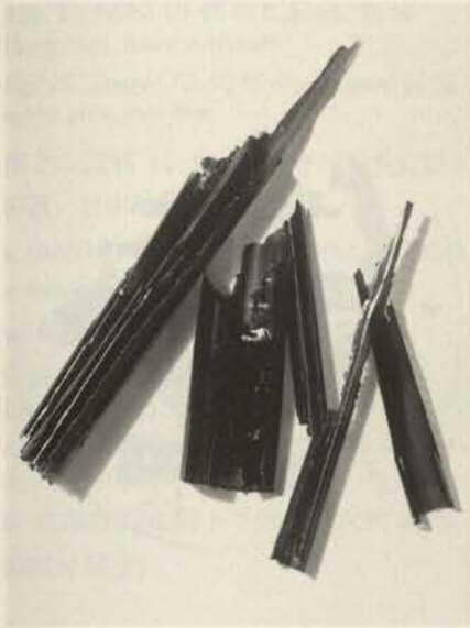
△ Abb.18. Probe 2 b: 30 % Rohlack, 70 % Resikleister, freier Aufstrich Fig. 18. Sample 2 b: 30 % raw lacquer, 70 % rice starch, free film
