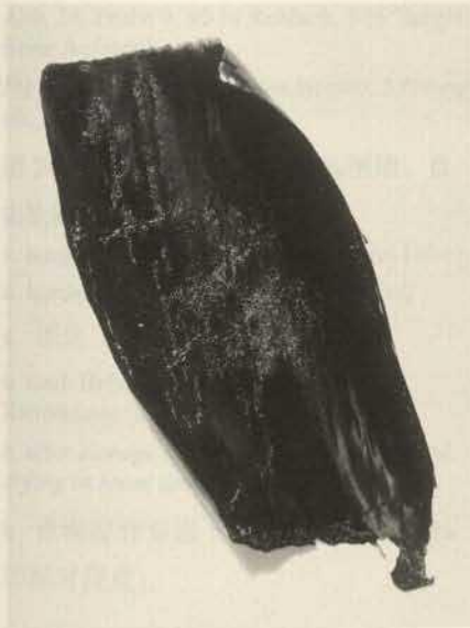
△ Abb.18. Probe 2 b: 30 % Rohlack, 70 % Resikleister, freier Aufstrich Fig. 18. Sample 2 b: 30 % raw lacquer, 70 % rice starch, free film
