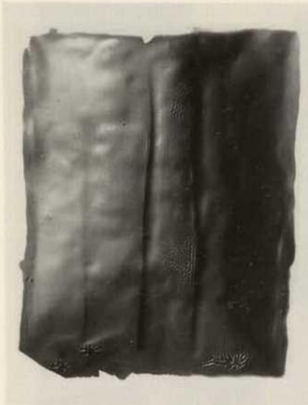
Abb. 16. Probe 1: Gereinigter Rohlack, freier Aufstrich Fig. 16. Sample 1: Purified row lacquer, free film
