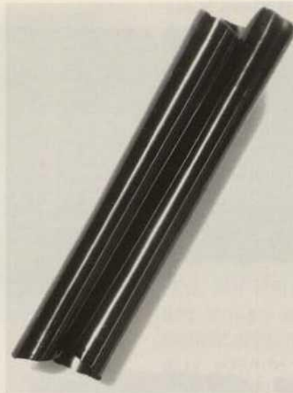
图 16. 试样 1: 纯化生漆, 自由涂刷
