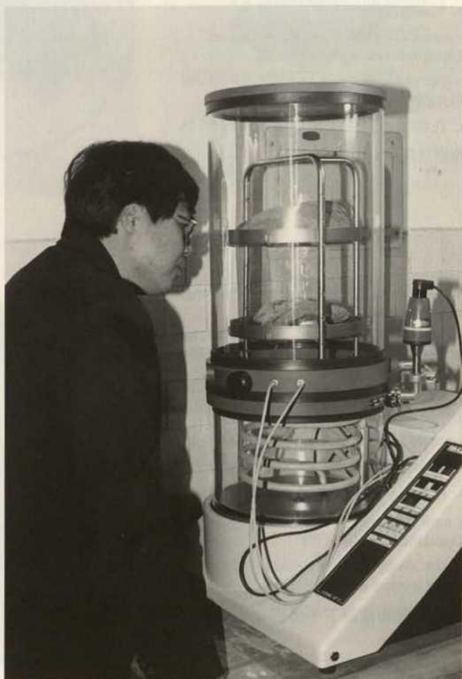
Begutachtung der Gefriertrocknung im Labor des Museums der Terrakottaarmee in Lintong durch Herrn Zhang Zhijun
