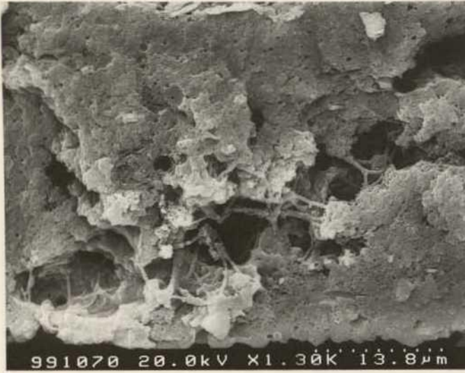
Abb. 11. Probe von F-004/96, REM-Aufnahme, 1300fache Vergrößerung, RE-Abbildung: in Rissen findet man die fadenartigen Strukturen des Fischleims; das Fadengerüst stabilisiert den Riß
