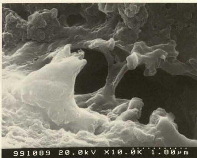
图 18. 试样 F012/98, 扫描电镜照片, 10000 倍, 两次电子成像; 图 17 局部。较宽的裂缝 (这里为 2 微米) 通过线状结构联为一体。裂隙侧面全部为聚合物层覆盖
