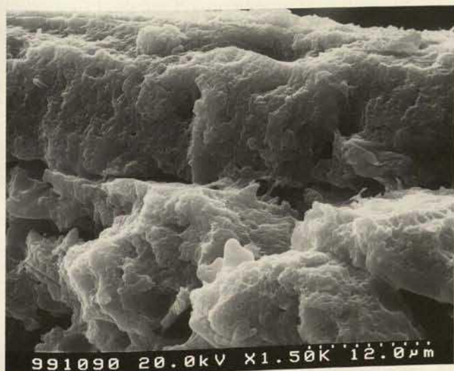
图 17. 试样 F012/98, 扫描电镜照片, 1500 倍, 两次电子成像; 经过填充裂隙, 脱离的表层漆重新与底层粘合
