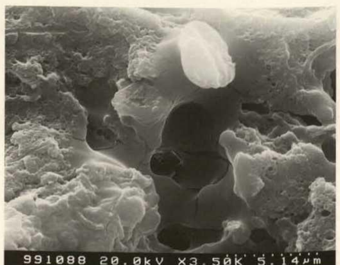
图 16. 试样 F012/98 扫描电镜照片, 3500 倍, 两次电子成像: 图 15 局部。典型的聚合保护膜的薄膜结构
