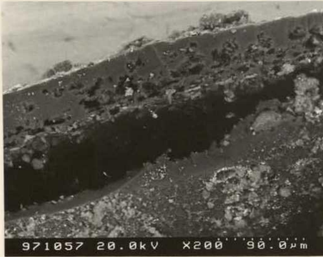
Abb. 3. Probe von F-009/96, REM-Aufnahme, 200fache Vergrößerung, RE-Abbildung: gleiche Lackschichtprobe wie Abb. 1, aber über Nacht getrocknet; die untere Schicht ist völlig kollabiert, in der oberen Schicht sind Grobporen entstanden
