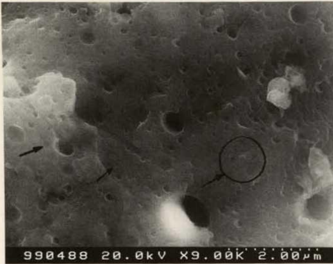
Abb. 7. Probe von F-003/96, REM-Aufnahme (Kryo), 9000fache Vergrößerung, SE-Abbildung: Ausschnitt aus Abb. 5 (untere Schicht), Mikroporen z. T. mit Wasser gefüllt (Pfeile) Temperatur ca. -130^{\circ}\text{C}
