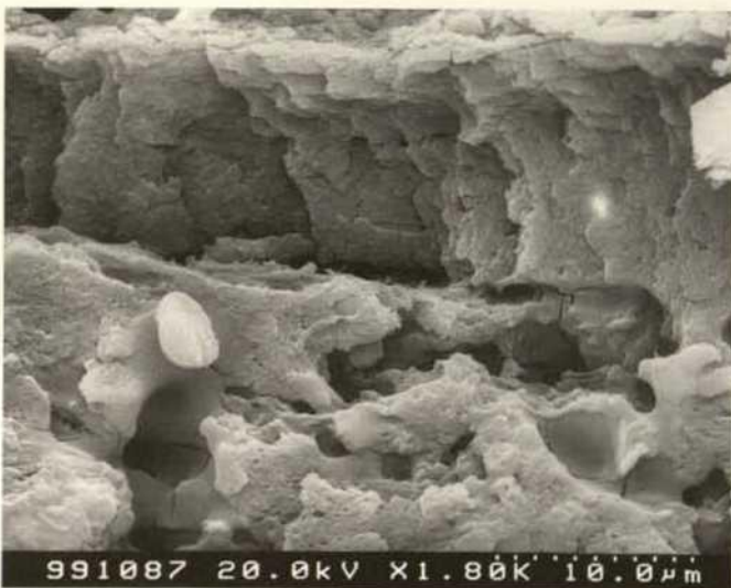
图 15. 试样 F012/98, 扫描电镜照片, 1800 倍扫描电子图像: 双层漆的断裂面。大孔的内壁覆衬着聚合物
