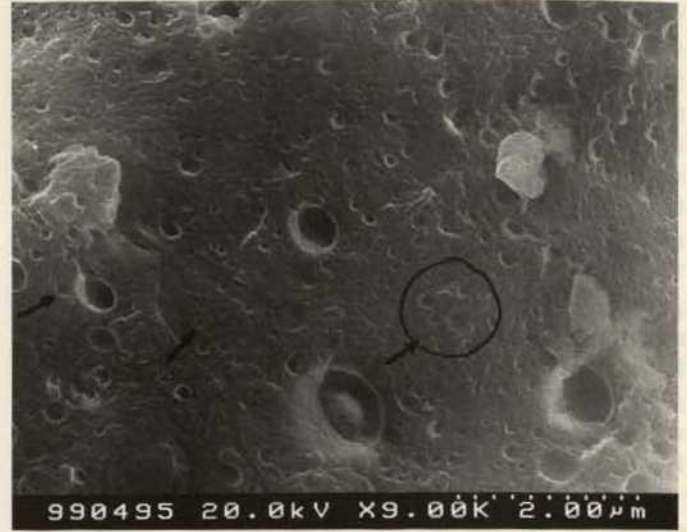
Abb. 8. Probe von F-003/96, REM-Aufnahme (Kryo), 9000fache Vergrößerung, SE-Abbildung: gleiche Stelle wie Abb. 7, allerdings bei ca. -10^{\circ}\text{C} ; das Wasser aus den mit Pfeilen gekennzeichneten Poren ist mittlerweile verdampft
