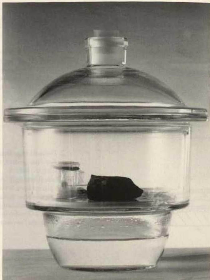
Abb. 4. Lagerung der Fragmente bei 99 % rF in Exsikkatoren Fig. 4. Storage of fragments at 99 % rh in desiccators
